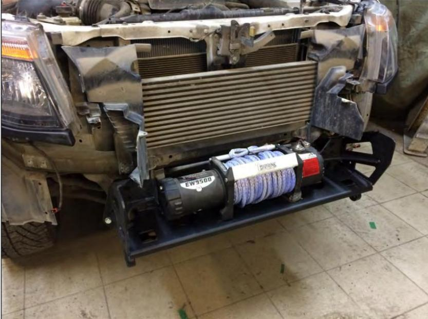
26. Placez le treuil sur le support (2) et fixez-le avec les boulons fournis avec le treuil.
