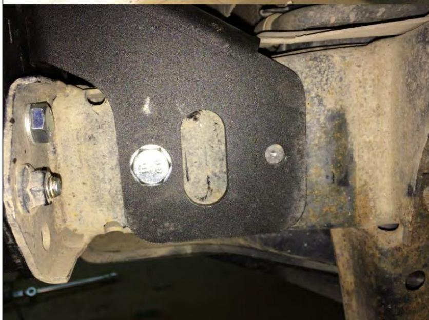
24. Fixez les supports de réglage (5, 6). Fixez-les au support du treuil à l'aide des boulons M 10x 30 (D), des écrous M 10 (L) et des rondelles 10 (P). Fixez provisoirement le support de réglage pour insérer l'écrou M12 (U) dans le trou OE à l'aide du boulon M 12x 30 (E) et de la rondelle 12 (Q).
