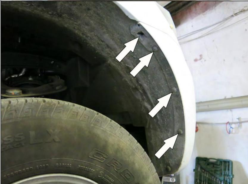
3. Retirez 3 vis de l'intérieur des ailes de chaque côté du véhicule.
