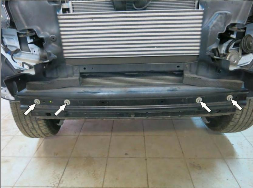
13. Retirez les 4 boulons du support de pare-chocs avant. Retirez le support.
