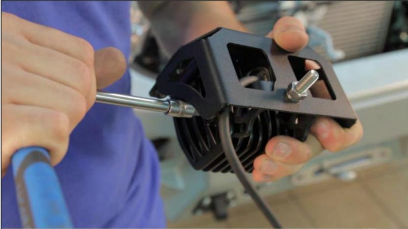
35 \* Montez les lumières LED dans les supports (3). Serrez les joints.
