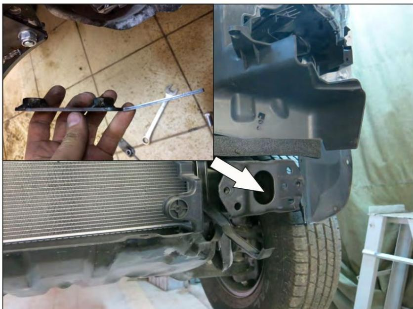
22. Placez les écrous d'insertion (U) dans le châssis.
