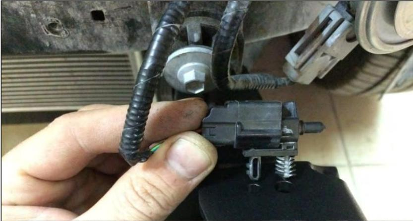
25. Fixez le capteur de température au support.
