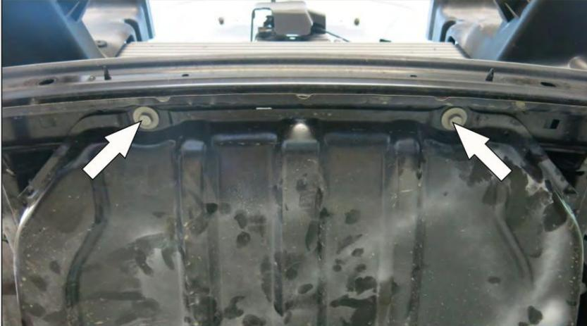
12. Retirez 2 boulons du raccord de la plaque de protection.
