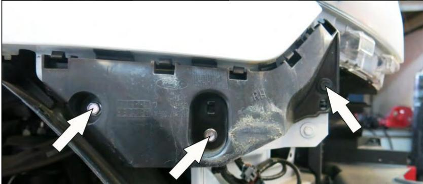
15. Retirez 3 boulons des supports en plastique des côtés gauche et droit du véhicule.
