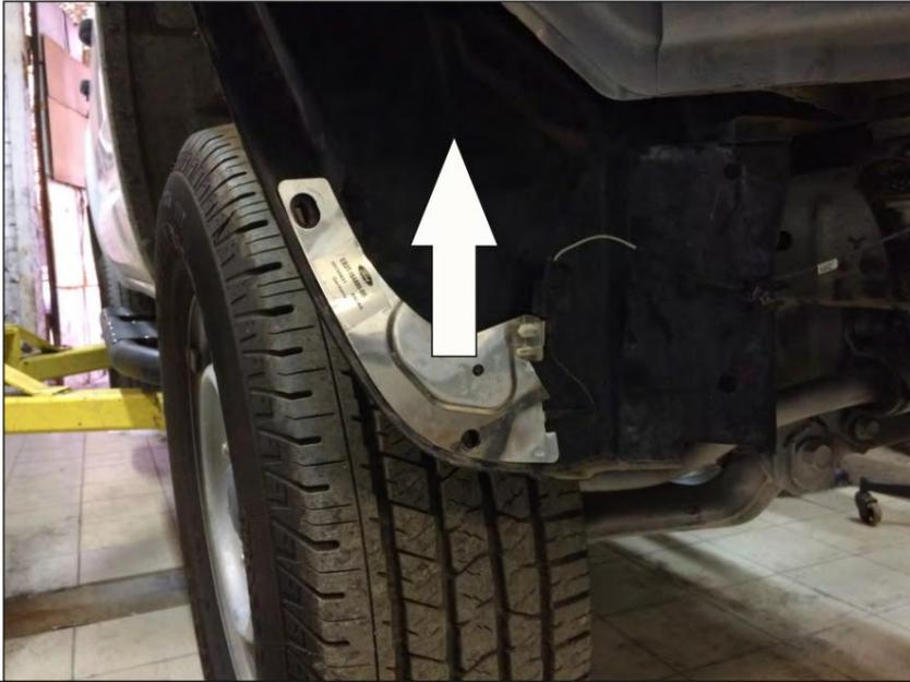
41. Du côté droit, décollez l'antenne du garde-boue. Déplacez l'antenne supérieure sous la barre.
