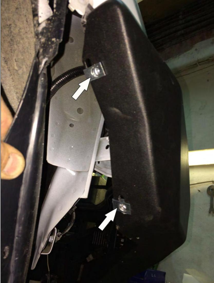
40. Placez les écrous en U M6 (1) sur le corps du pare-chocs (1).
