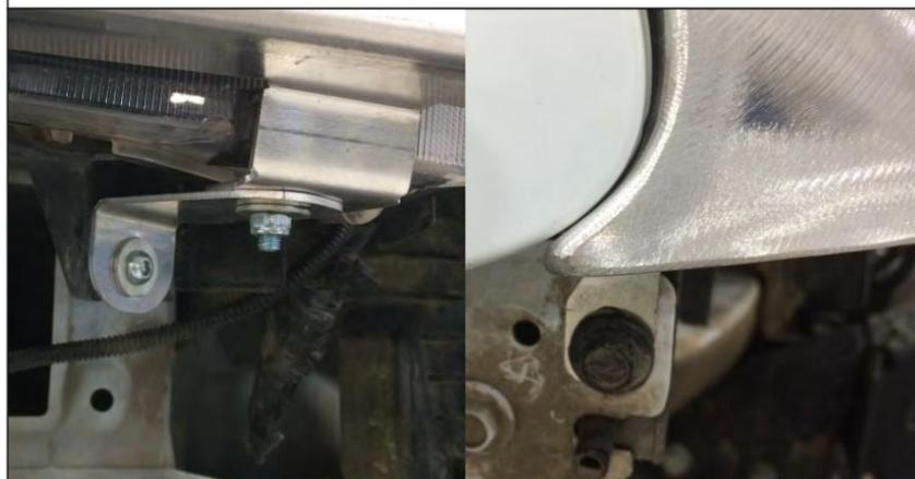
18. Installez le panneau sous le phare. Fixez le support sous le phare. Fixez-les avec la vis M 6x 20 (F) et les rondelles penny 6 (N).
