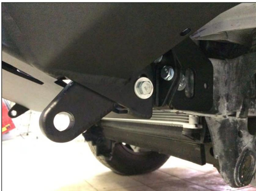
37. Installez le corps du pare-chocs (1) sur le support du treuil (2). Fixez sa partie inférieure aux supports à l'aide des boulons M 10x 30 (D), insérez les écrous M 10 (T) et les rondelles 10 (P).
