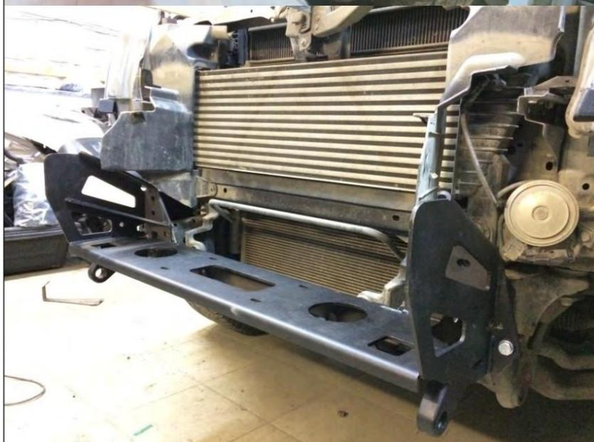
23. Installez le support de treuil (2) sur le châssis. Fixez-le avec des boulons M 10x 30 (D), des écrous M 10 (L) et des rondelles 10 (P).
