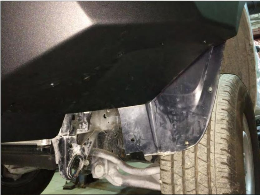
43. Installez les volets (7, 8) à l'aide de la vis M 6x 20 (F) et des rondelles 6 (M). Assurez-vous que les volets sont fixés à l'intérieur du pare-chocs et non à l'extérieur.
