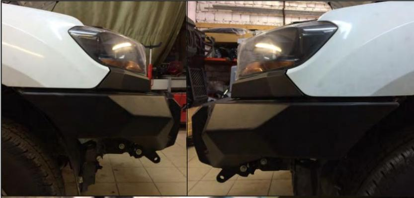
39. Ajustez le pare-chocs jusqu'à ce que vous ayez un espace égal entre la carrosserie du véhicule et le pare-chocs des deux côtés. Serrez les boulons après cela.
